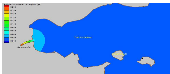
Gambar 6. Model sebaran konsentrasi sedimen tersuspensi untuk simulasi sedimen yang keluar dari Sungai Anafre tersusun atas pasir (Skenario 1) pada kondisi surut. Warna mengindikasikan konsentrasi sedimen tersuspensi 0,026 - 0,200 g/L
